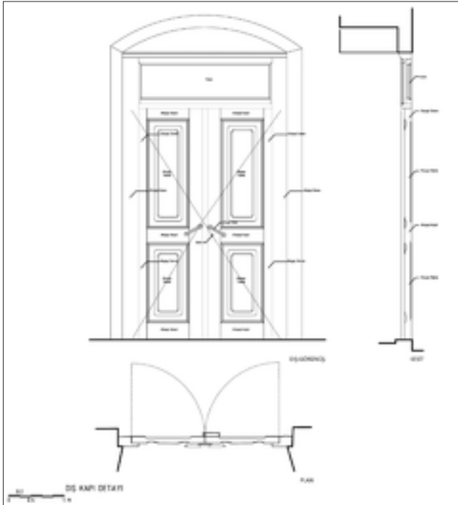
Şekil 17: Restorasyon dış kapı detayı.
