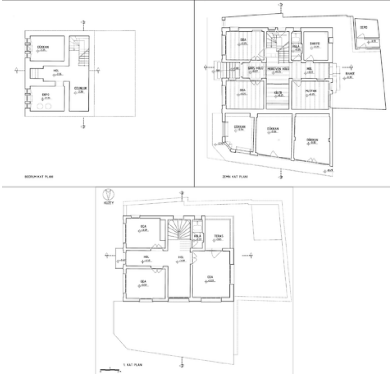
Şekil 19: Restorasyon bodrum, zemin ve 1. kat planları.
