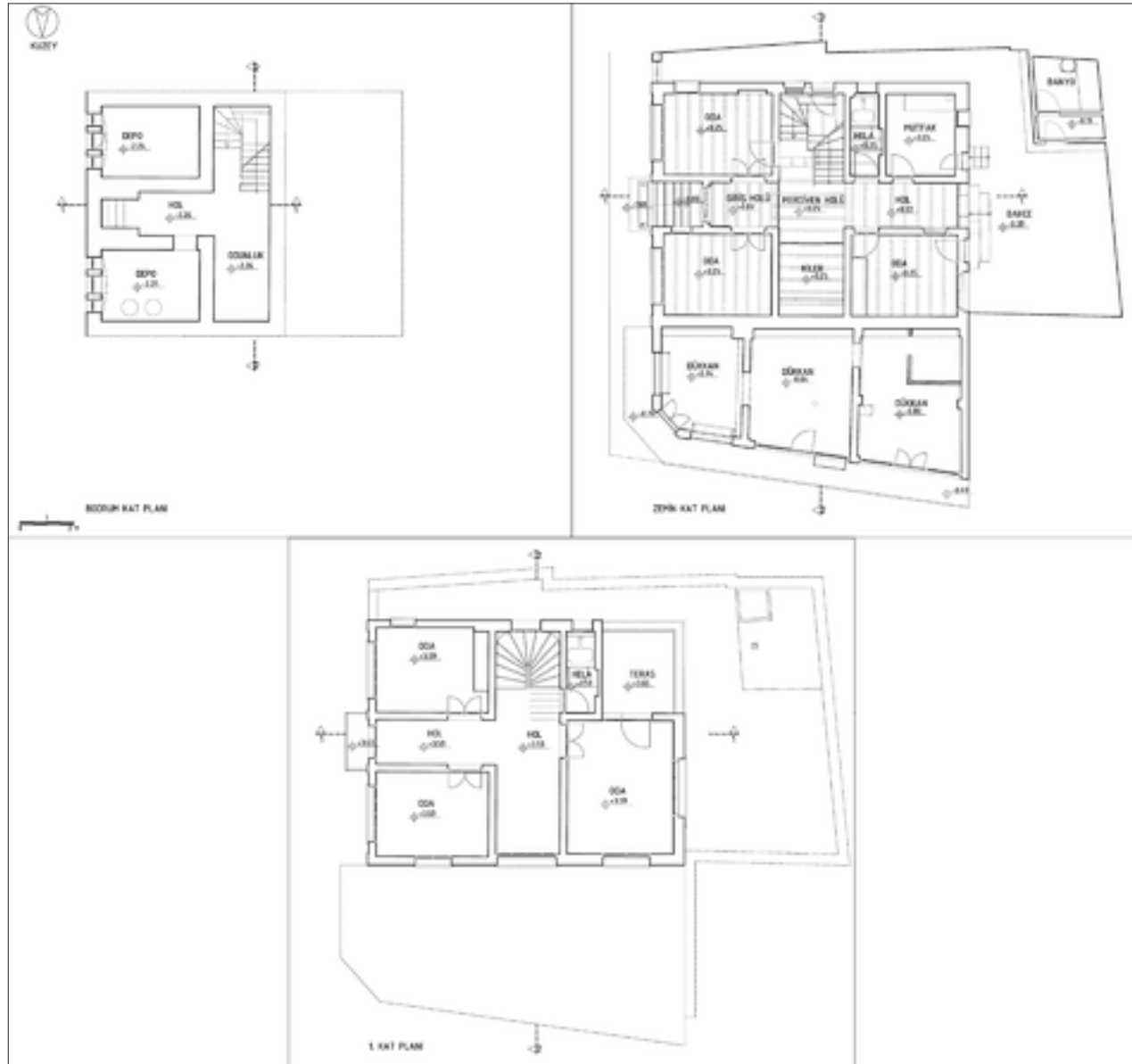
Şekil 10: Rölöve bodrum, zemin ve 1. kat planı.
