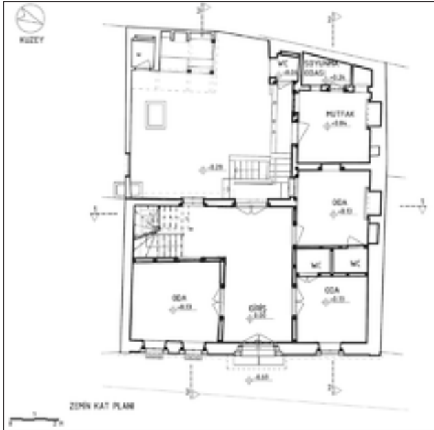
Şekil 21: Zemin kat planı restorasyon önerisi.
