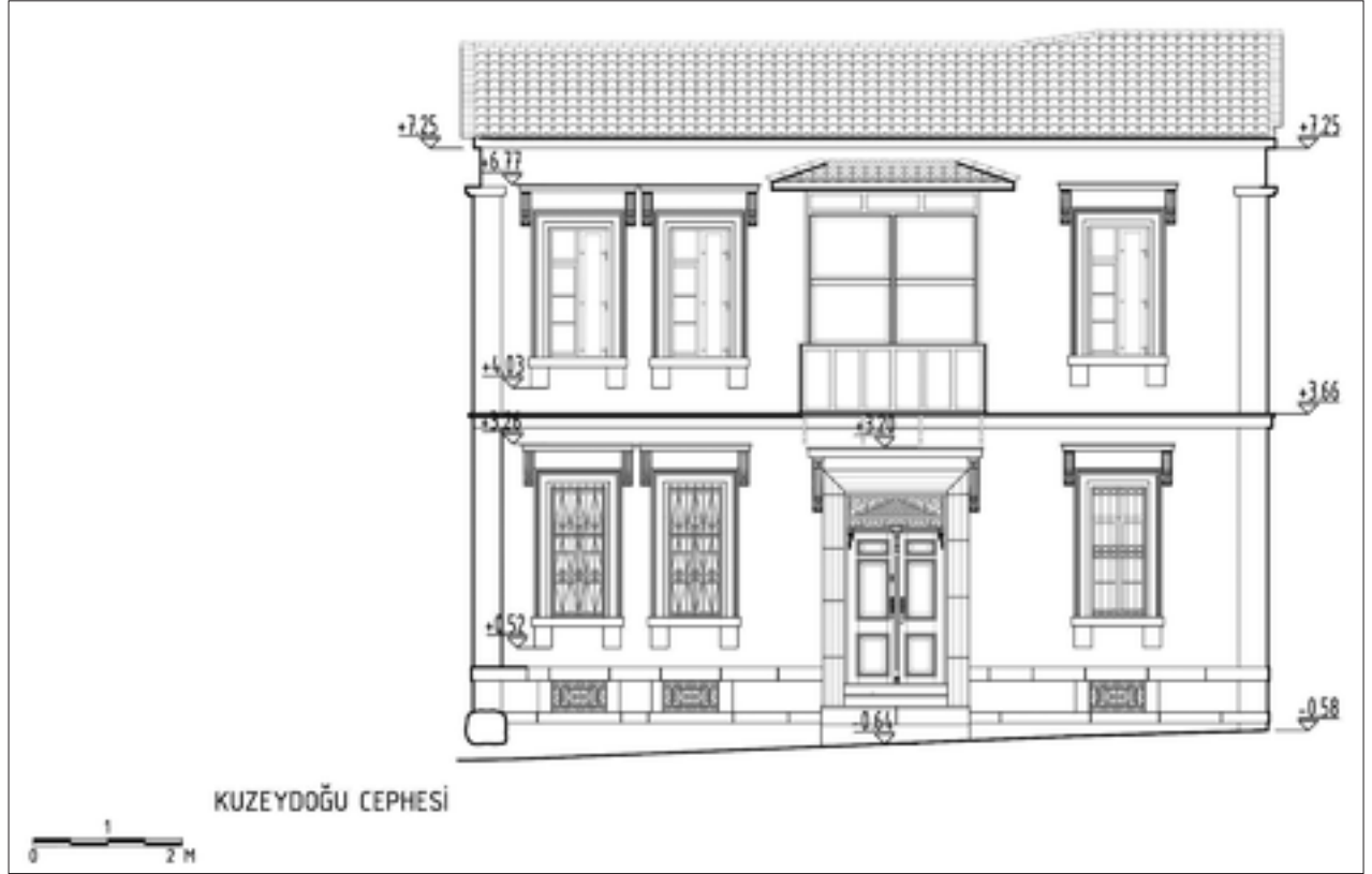
Şekil 19: Ön Cephe restorasyon önerisi.
